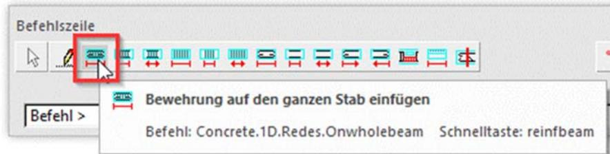
Das Fenster **Parameter der Bewehrung** wird eingeblendet. Sie können nun entscheiden ob die Vorlage mit den Parametern, wie Durchmesser der Bewehrung, von den Voreinstellungen im Stahlbetonmenü eingefügt werden soll, oder ob die Durchmesser von der Vorlage verwendet werden sollen. Wir behalten die Voreingestellte Option.
