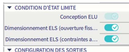
Après avoir activé ces options, l'augmentation du ferrillage longitudinal peut être générée, dans ce cas la valeur  $\Delta A_{s,ser,1}$ . SCIA déterminera les efforts principaux  $m_{Ed,car}$  et  $m_{Ed,QP}$  dans le but de calculer l'apparition des fissures à partir de  $A_{s,ult}$ , le ferrillage ELU calculé. En plus des efforts principaux, il est aussi nécessaire de calculer la quantité de ferrillage dans la direction des efforts principaux.
