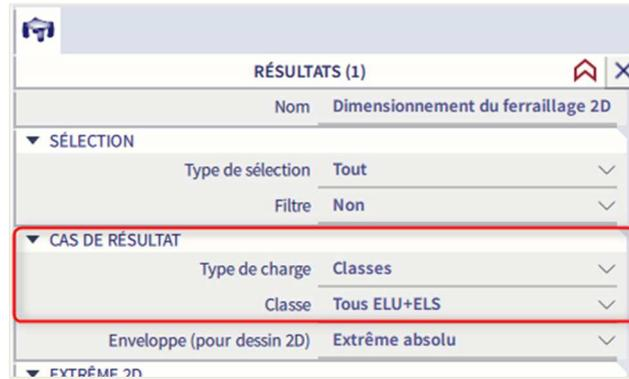
La première étape de la procédure de calcul consiste en la détermination de  $A_{s,req}$  à l'ELU pour chaque direction et pour chaque face. Pendant cette étape, SCIA déterminera deux valeurs, et plus particulièrement :
