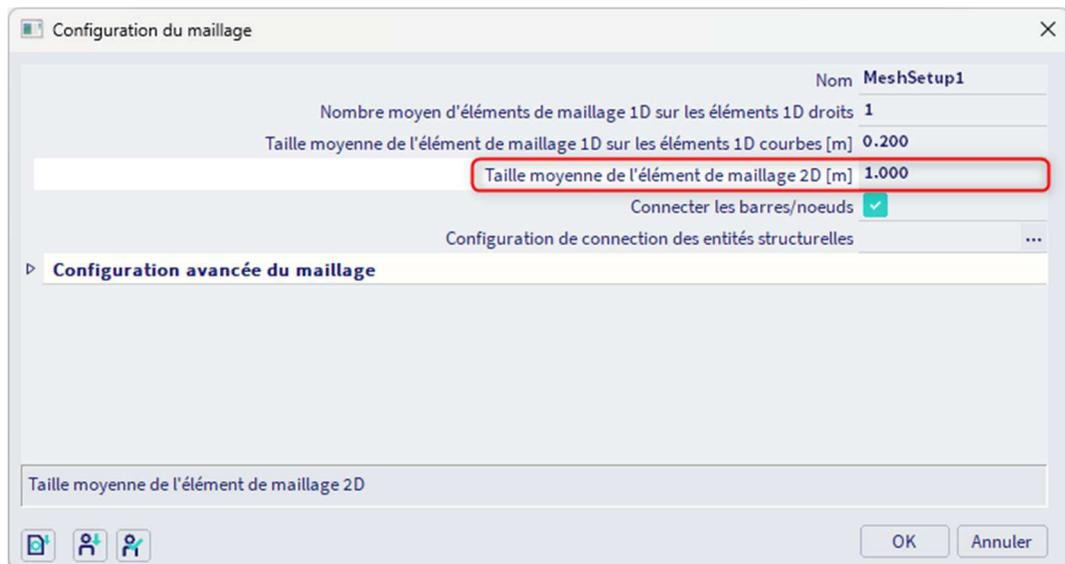
La taille de maille peut également être modifiée dans la fenêtre d'analyse EF avant le lancement du calcul :
