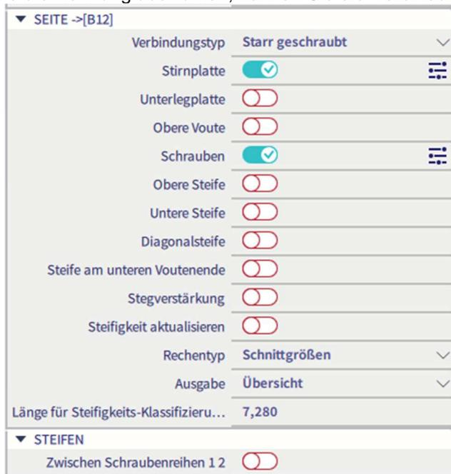
Um die Verbindung zu erstellen, müssen Sie den Verbindungstyp auswählen und die Komponenten der Verbindung überprüfen. Um die Komponenten zu bearbeiten, drücken Sie auf das Verwaltungssymbol neben der Komponente.
