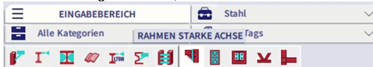
Nachdem Sie einen Verbindungstyp ausgewählt haben, sollten Sie den Knoten auswählen, dem Sie die Verbindung hinzufügen möchten. In diesem Beispiel wird eine Verbindung für die starke Achse ausgewählt. Nachdem Sie den Knoten ausgewählt haben, wird auf dem Knoten die folgende Kennung angezeigt:
