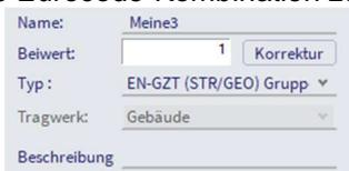
Die Beiwerte können nicht bearbeitet werden Sie werden automatisch auf den Lastfall in der Kombination geladen.
