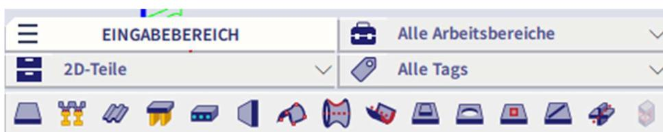
**Platten:** Dieses 2D-Element können Sie durch Zeichnen des Rands definieren. Die Form des Rands können Sie mit der Symbolleiste unten ändern (sie wird unter SCIA Eingabeleiste angezeigt, wenn Sie die Platte zeichnen). Dieses Element hat automatisch den Typ 'Platte(90)'.
