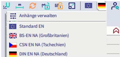
Damit werden die Normeinstellungen von EN-1990 geöffnet. Hier finden Sie die Tabelle mit den Psi-Faktoren. Sie können die Werte bei Bedarf bearbeiten.
