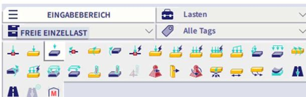
Sie können nur einem 2D-Bauteil eine freie Einzellast zuweisen. Sie müssen die Geometrie in der **Ebene XY** des aktuellen BKS definieren. Wenn Sie eine Kraft zeichnen, hat sie nur eine X- und Y-Koordinate. Sie wird an jedem 2D-Bauteil generiert, das einen Punkt mit dieser X- und Y-Koordinate hat. Das bedeutet, dass, wenn Sie eine Platte über dieser Einzellast haben, die Kraft auch auf dieser Platte generiert wird.
