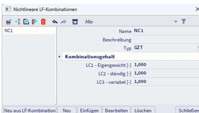
In diesem Fenster können Sie die Beiwerte festlegen und die Imperfektionen bearbeiten. Es gibt auch eine Funktion zum automatischen Erstellen nichtlinearer LF-Kombinationen aus dem Kombinationsmenü. Dies kann mit der Schaltfläche 'Neu aus LF-Kombination' ausgeführt werden.
