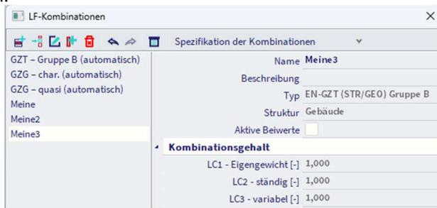
Wenn Sie den Inhalt der Gruppenkombination anzeigen möchten, drücken Sie die Schaltfläche 'In lineare Kombinationen auflösen'. Dadurch wird diese Kombination in einzelne 'lineare Kombinationen' aufgeteilt.
