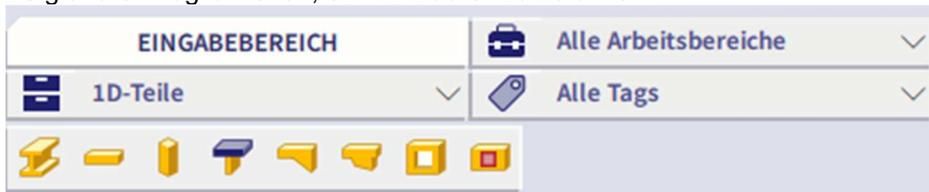
**Bauteil:** Mit dieser Option können Sie ein 1D-Bauteil zeichnen, indem Sie zwei Punkte definieren. Dieses Element hat automatisch den Typ 'allgemein(0)' oder 'Stab(80)'. Die Form des Bauteils können Sie über die Symbolleiste unten ändern (sie wird unter SCIA Eingabeleiste angezeigt, wenn Sie das Bauteil zeichnen).
