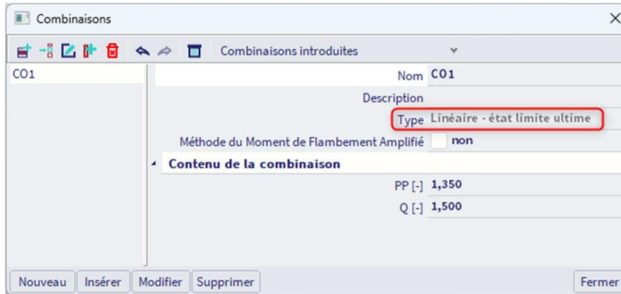
Cette combinaison linéaire doit être sélectionnée dans la « Configuration du solveur » pour lancer « Soil-In » :
