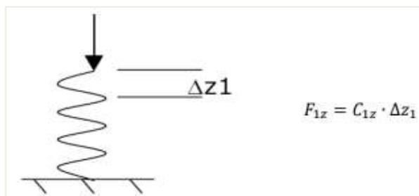
Les paramètres de sol horizontal  $C_{1x}$  et  $C_{1y}$  indiqueront un frottement entre la plaque et le sol. Davantage d'informations peuvent être récupérées dans la littérature pour le calcul de ces paramètres. Pour les sols normaux (sans roche, tourbe ...), une valeur type de 10% de la rigidité verticale  $C_{1z}$  peut être prise.
