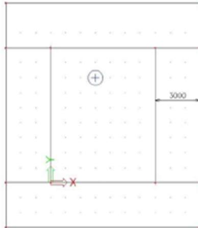
Ajouter le type d'appui surfacique « Soil-In » sous ces plaques.
