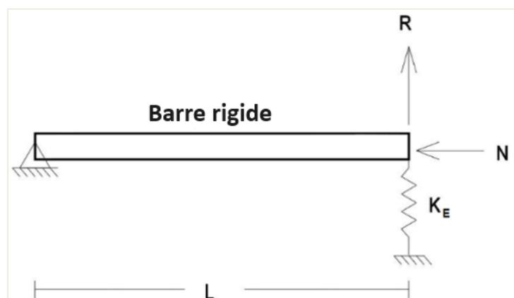
Cette poutre de longueur  $L$  a un rotule à gauche et un appui à ressort flexible à droite avec rigidité:  $K_E$ . Deux charges ponctuelles sont entrées sur la poutre : une force verticale  $R$  et une force de compression  $N$ .
