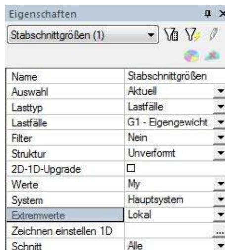
4. Für **Auswahl** wird **Aktuell** eingestellt, bei **Lasttyp Lastfälle**. Als ersten Lastfall lassen wir das **G1 – Eigengewicht** anzeigen. **Werte** wird auf **My** gesetzt, für **Extremwerte** wird die Option **Lokal** gewählt.
