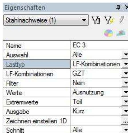
4. Die Ausnutzungsgrade werden nach Betätigung von **Aktualisieren** im Modell dargestellt.
