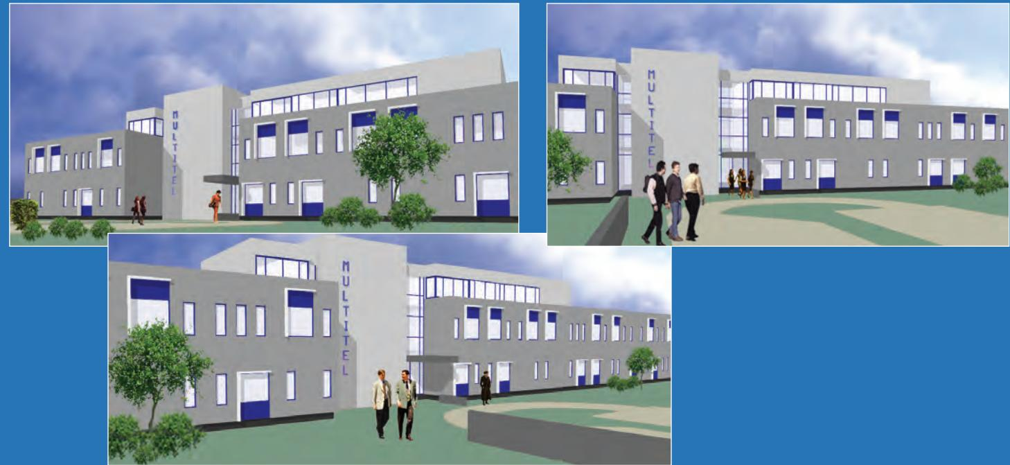
L'alternance des parties pleines et vitrées, la présence ou non d'allèges pleines, la disposition d'éléments extérieurs propres à maîtriser de manière individualisée manuelle l'ensoleillement et la luminosité, l'isolation et l'inertie thermique des matériaux utilisés... sont autant de moyens à mettre en œuvre en concordance avec l'utilisation fonctionnelle et confortable des locaux.
